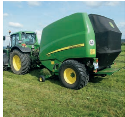
Bild 3: John Deere Rundballenpresse 960 während einer Messfahrt im Graseinsatz
