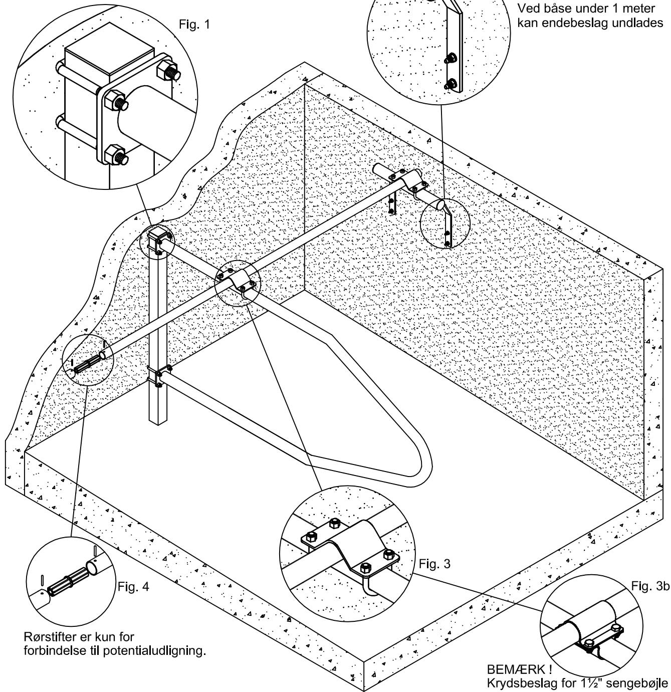
**Fig. 1** Monteres med: 12mm firkantbøjle 70 x 70 og M12 låsemøtrik
