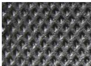
undersideprofil: 5 mm høye, deformerbare knoter
