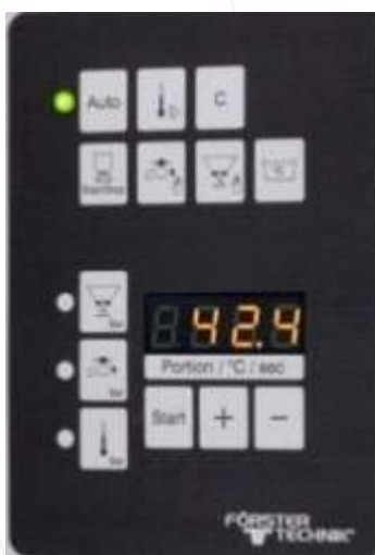
Styrepanel med digitalt display og hurtigtaster
