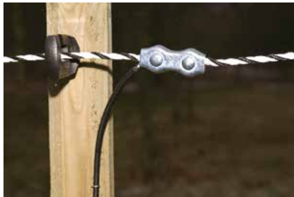
Bilde 13. Trådskjøt fra apparat til gjerde.
