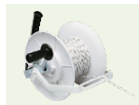
Bilde 20. Vinde med gear og trådfører. Utstyrt med automatisk låsing. Rommer ca 500 m tråd, 200 m av 12 mm polyband.
