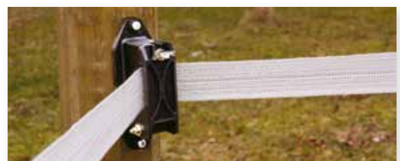
Bilde 2b. Med band, monter hjørne-/endeisolator i hjørnene.
