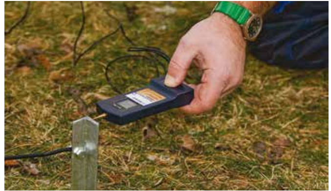
Bilde 17. Mål spenningen med DeLaval digitale voltmeter så får du sikker beskjed om alt er OK.
