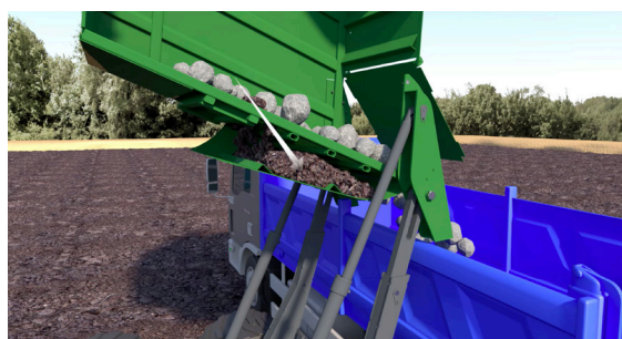
3. Eventuell jord som er igjen, havner i en beholder som er plassert bak bakveggen på steintanken og tømmes når steinplukkeren tipper.
