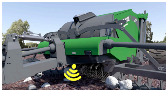
1. Steinen kommer inn i maskinen, over såldet som er plassert under løftetrommelen.
