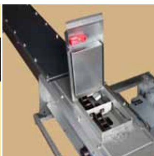
Overfyllingsluke/inspeksjonsluke med sikkerhetsbryter.
