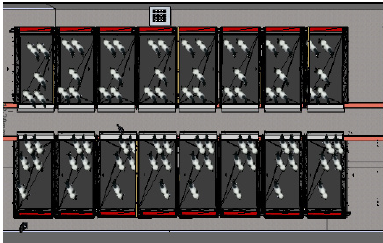
Kalvavdelning med 16 Gruppboxar. Totalt är ytan 21 x 13 meter med 80 kalvplatser.
