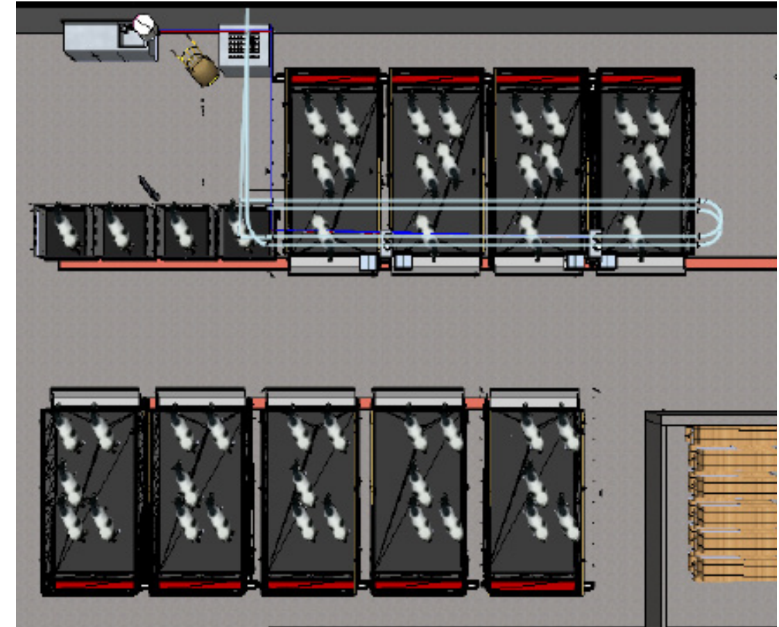
Kalvstall med 4 Singelboxar, 4 Gruppboxar med Kalvamma och 5 Gruppboxar för avvanda kalvar upp till 4-5 månaders ålder. Väl tilltagna trymmen för mjölkblandning samt ströför-råd. Totalt är ytan 14 x 18 meter med 49 kalvplatser.
