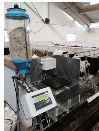
Installation av automatisk kraftfodertilldelning (ej mjölktilldelning)
