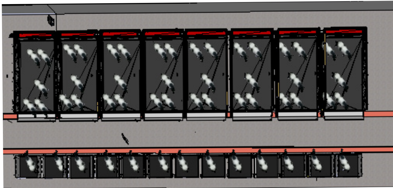
Kalvavdelning med 13 Singelboxar och 8 Gruppboxar. Totalt är ytan 21 x 10 meter med 53 kalvplatser.
